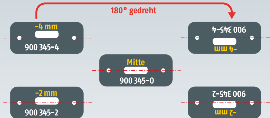
Verstellprinzip: 2 Basisschrauben mit 3 Bodenmulden = 5 verschiedene Lochpositionen
